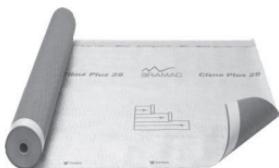
Fólia Bramac Clima Plus 2S môže byť použitá v dvojplášťových aj trojplášťových strechách. V prípade dvojplášťových striech musí byť položená celoplošne na rozmerovo a tvarovo stabilnú tepelnú izoláciu alebo debnenie vždy reflexnou vrstvou hore, prípadne môže byť voľne natiahnutá na krokvách.
