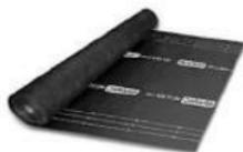
Fóliu odporúčame použiť v prípadoch, ak je dodržaný bezpečný sklon strechy ( $22^\circ$  pre veľkoformátové škrídly,  $25^\circ$  pre Tegalit a Revívu). Nedifúzna fólia Bramac Veltitech 120 sa môže použiť len v trojplášťových strechách. Nesmie sa klásť na debnenie, ani na tepelnú izoláciu. Pokladá sa potlačenou stranou smerom hore.
