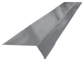
Odkvapový plech pod fóliu Bramac 7° slúží na odvodnenie poistnej hydroizolačnej fólie Bramac Top RU pri strechách s nízkym sklonom ak je použitý systém Bramac 7°. Poistná fólia Bramac Top RU sa prilepí na plech pomocou lepiacej pásky a Lepiacie hmoty pre vodotesné napojenie fólií Bramac 7°.
