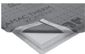
Tepelne izolačný prvok pre zateplenie existujúcich strech s pôvodnou medzikrovovou izoláciou. Pri strarsích objektoch nie je možné garantovať dobrú vzduchotesnosť pôvodnej konštrukcie. Preto pre zabezpečenie vzduchotesnosti jestvujúcej konštrukcie odporúčame položiť pod tieto panely strešnú fóliu Bramac s prelepenými spojmi.
