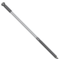
Systémové vruty Bramac Therm s dvojitým závitom slúžia na bezpečné pripojenie dosiek Bramac Therm, na prenos statického zaťaženia a na zabezpečenie proti sacímu účinkom vetra. Rozdielne stúpanie spodného a horného závitu vrutov Bramac Therm zaistí dotlačenie kontralaty o cca. 2 mm k izolačným doskám. Vruty sú s povrchovou úpravou Durocoat, ktorá zabezpečuje optimálnu ochranu pred koróziou a vďaka obsahu teflónu taktiež jednoduchšiu montáž.
