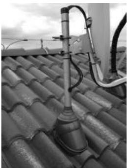
Anténny držiak univerzálny je možné použiť na ukotvenie antén, satelitov a iných prvkov na šikmé strechy. Vyznačuje sa jednoduchou montážou priamo na kontralaty. Celý prvk je upevnený na streche nad poistnou hydroizoláciou, čím sa vyhneme zložitému riešeniu prestupov cez fóliu. Balenie obsahuje všetky potrebné prvky pre montáž. Pre prestup cez krytinu sa použije nadstavec Durovent pre anténu a satelit.
