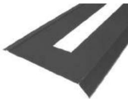
Norma STN 73 1901: 2005 Navrhovanie streich stanovuje, že vrstva poistnej hydroizolácie musí byť v odkvapovej hrane odvodnená. Norma dokonca stanovuje toto odvodnenie pomocou dvojitého žľabov, čo je riešenie vhodné hlavne v extrémnych prípadoch. V bežnej praxi, t.j. sklon strechy je väčší ako bezpečný, plne vyhovuje odvodnenie poistnej hydroizolácie pomocou odkvapového plechu. Odkvapový plech je jedným z dôležitých prvkov riešenia odkvapovej hrany každej bezpečnej strechy.
