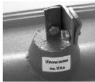
Nadstavec slúži na montáž drôtu bleskozvodového vedenia v prípadoch, ak je potrebné jeho priečne vedenie. Namontovaním nadstavca na jestvujúcu bleskozvodovú škridlu alebo bleskozvodový hrebenáč dosiahne- me pootočenie svorky o 90°.
