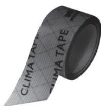
Clima Tape zabezpečuje vzduchotesné utesnenie priečnych spojov fólie Bramac Membran 100 2S, vzduchotesné napojenie hladkých prestupov fólií (napr. presahov krokiev cez pomúrnicu), vzduchotesné napojenie prestupov fólií (napr. komínové telesá, strešné okná) a vzduchotesné napojenie menších prestupov vedených tesniacou manžetou. Veľkou výhodou pásky Climatape je mimo-riadne vysoká dotyková adhézia.
