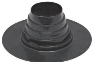
Manžeta z termoplastického polyuretánu pre napojenie kruhových prestupov rôznych priemerov k podkladovej vrstve Bramac Premium WU je možné ju upevniť zváraním pomocou teplovzdušnej pištole, alebo Lepiacou hmotou Premium WU.
